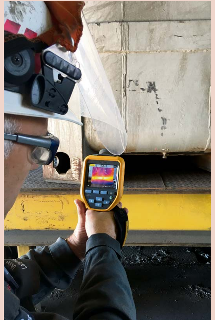
Bruno Vaillancourt prend la température d'un creuset de transport.
