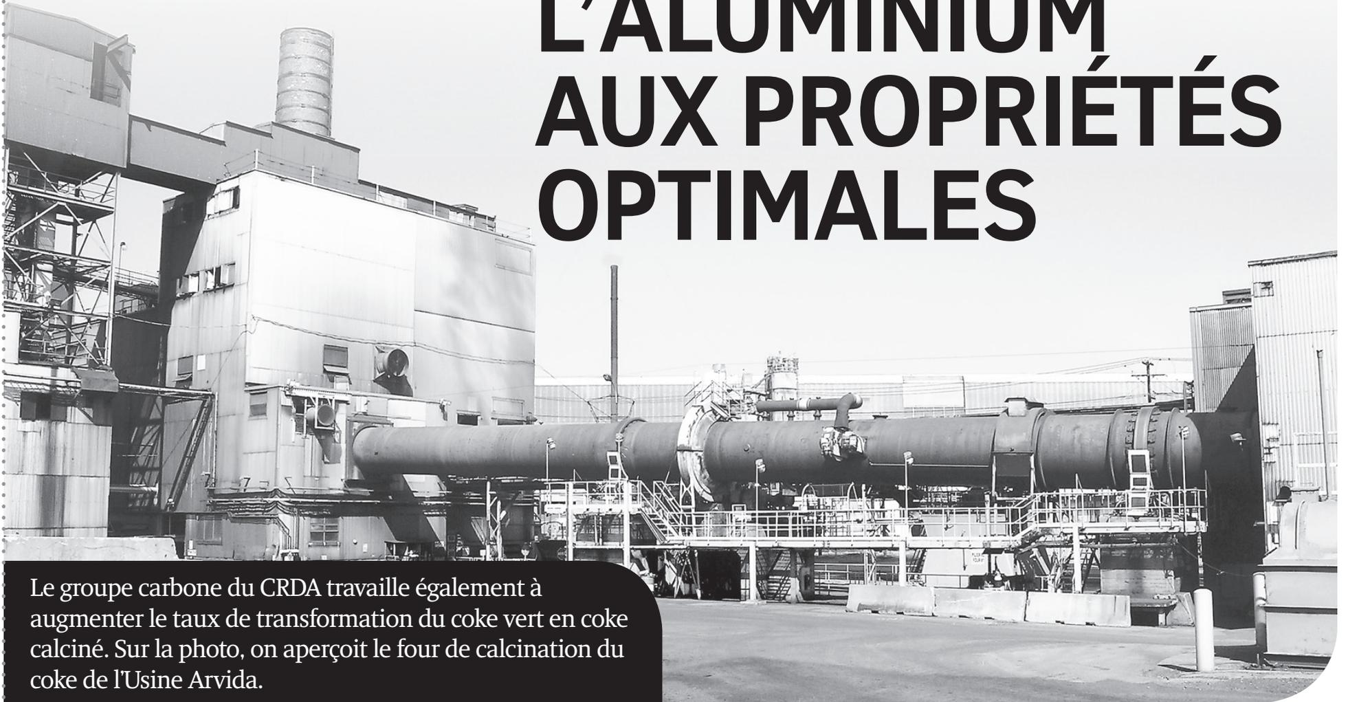
Le groupe carbone du CRDA travaille également à augmenter le taux de transformation du coke vert en coke calciné. Sur la photo, on aperçoit le four de calcination du coke de l'Usine Arvida.
