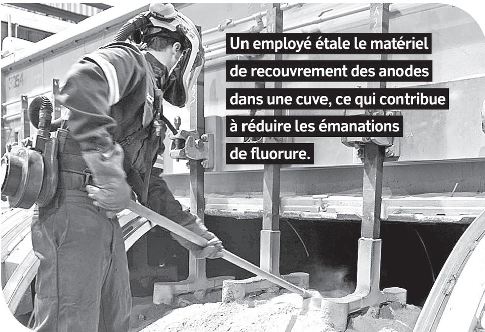
Un employé étale le matériel de recouvrement des anodes dans une cuve, ce qui contribue à réduire les émanations de fluorure.
